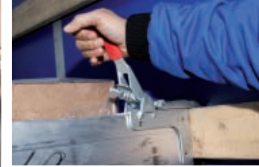
Der Klemmbalken sichert die Ladung gegen Verrutschen.
